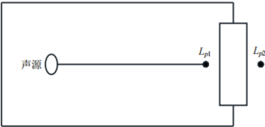
图 4-5 室内声源等效为室外声源图例
