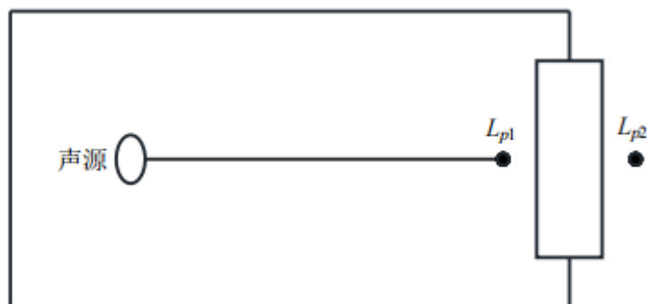
图 4-2 室内声源等效为室外声源图例
