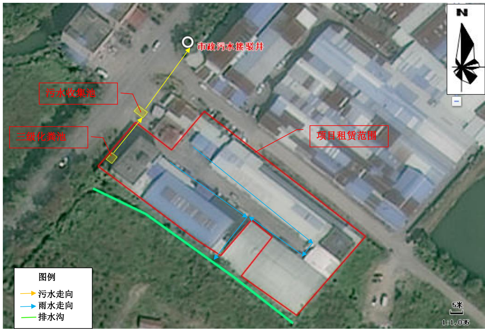
附图 5-2 项目厂区雨污管道走向图
