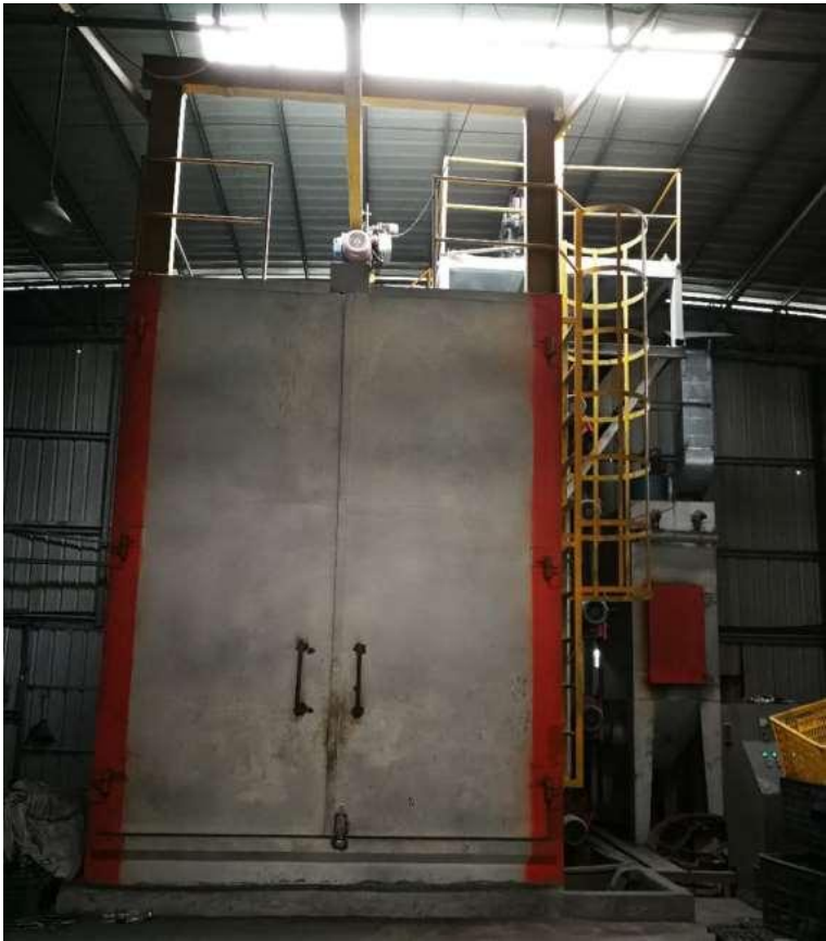
图 4-1 本项目打砂机外形示意图
