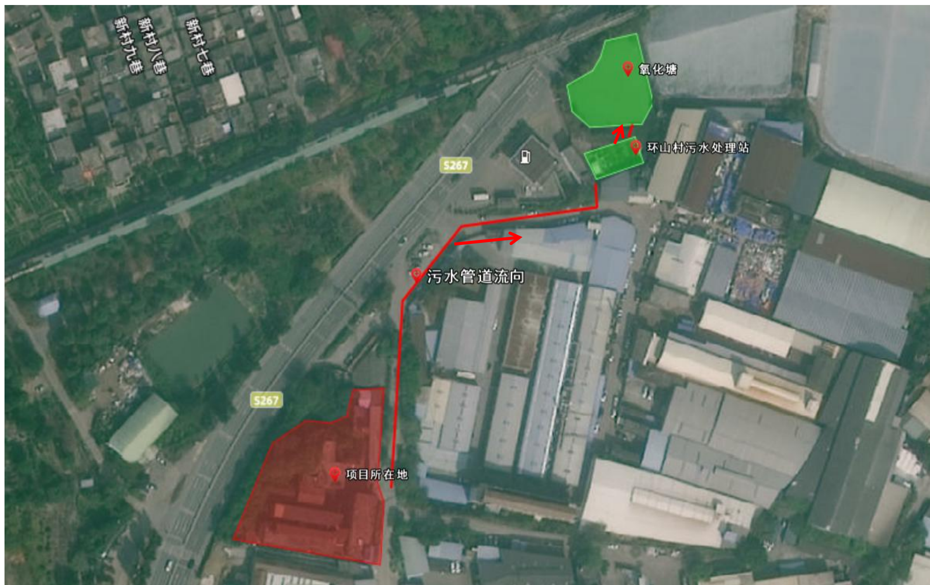
附图 17：项目近期废水流入环山村污水处理站流向图
