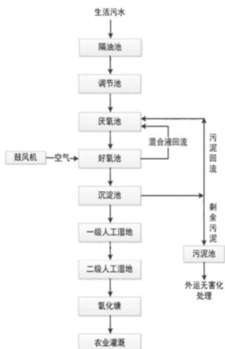
图4-2 花都区炭步镇环山村工业园污水处理站工艺流程图
