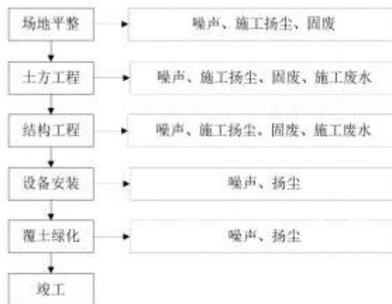
图 2-5 二期工程项目施工工艺流程图
