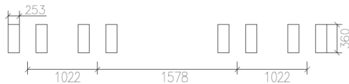
图 3.9-2 流动荷载走轮布置图
