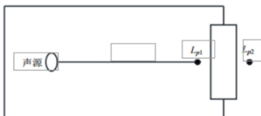
图 4-2 室内声源等效为室外声源图例
