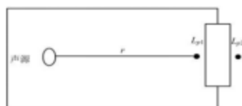
图 4-6 室内声源等效为室外声源图例
