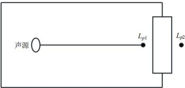
图 4-3 室内声源等效为室外声源图例
