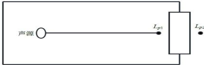
图 4-3 室内声源等效为室外声源图例
