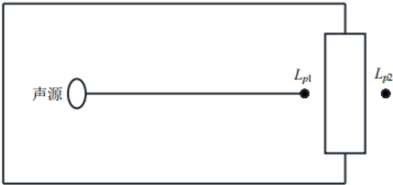
图 4-6 室内声源等效为室外声源图例
