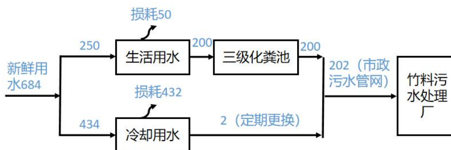
图 2-1 本项目水平衡图 (t/a)
