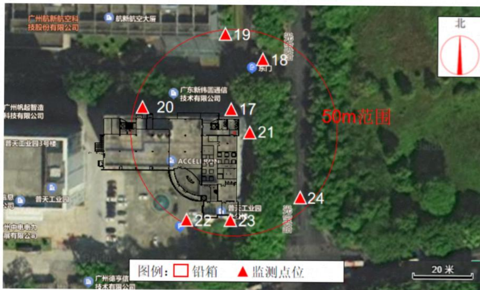
图 8.2-2 铅箱位置及周围 \gamma 辐射剂量率检测布点图（公司外） 检测布点示意图
