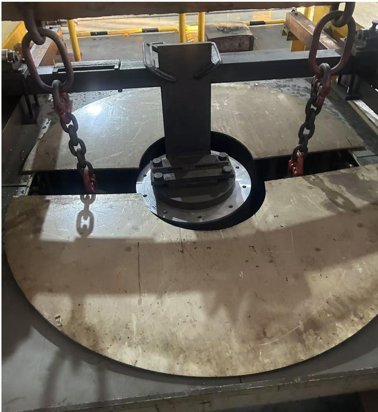
图3.10-1 镀铬槽加盖密闭示意图
