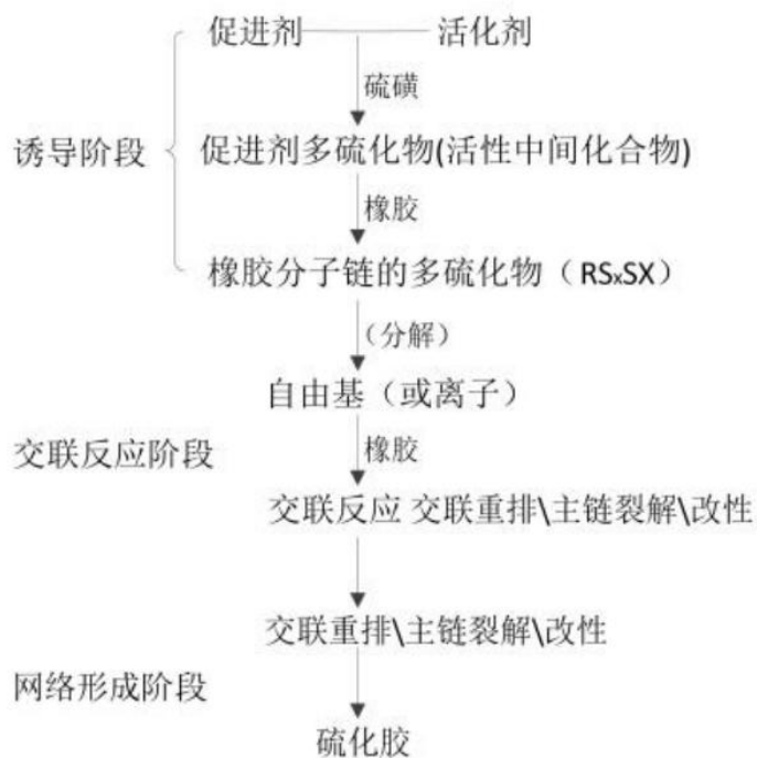
图 2-3 项目橡胶硫磺硫化反应流程图
