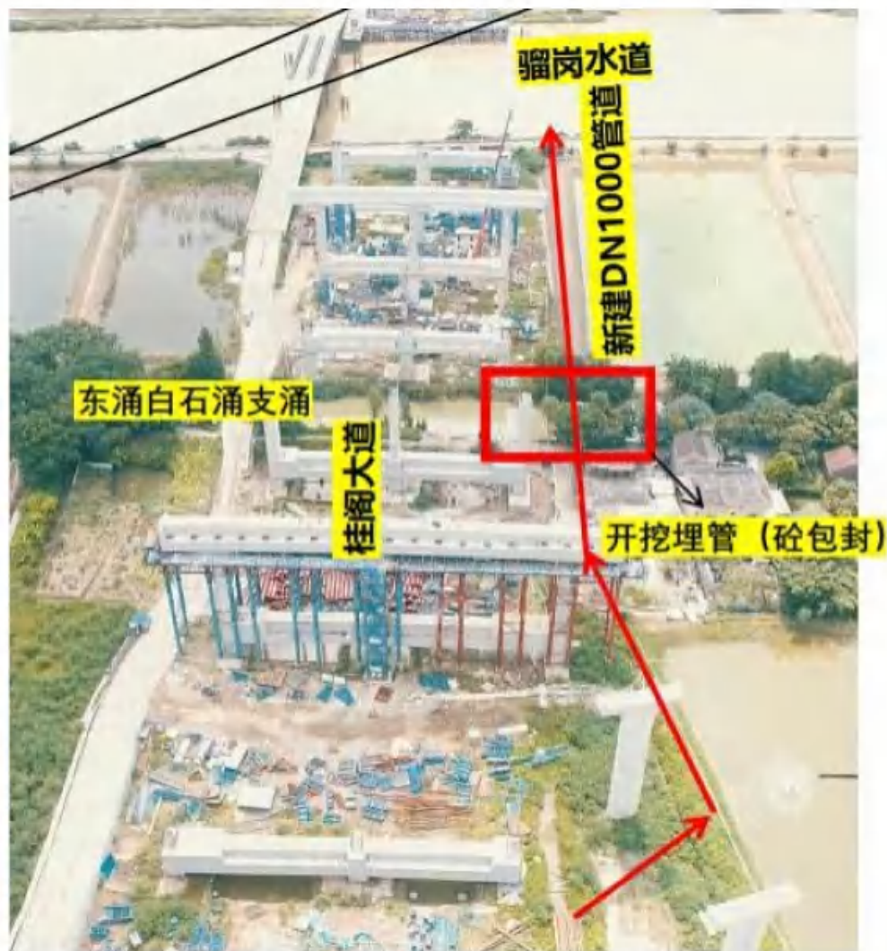
图 2-10 （长莫公路 ~骊岗水道）段管位示意图
