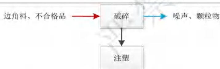
图 2-5 破碎工艺流程图
