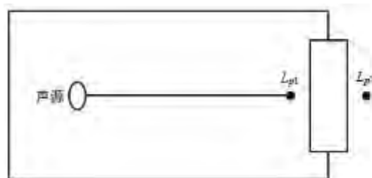
图 4-2 室内声源等效为室外声源图例
