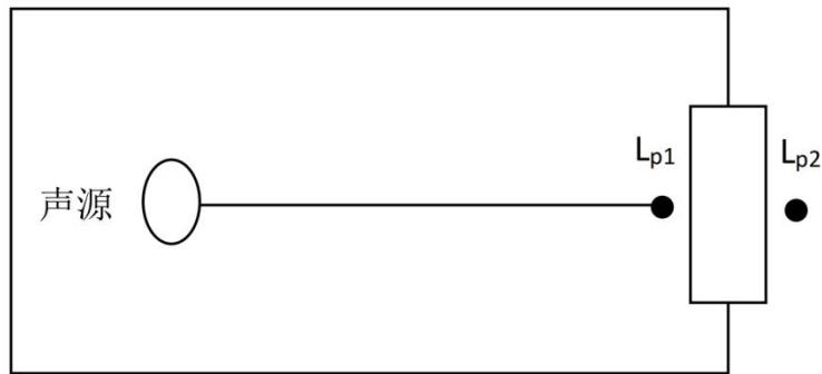
图 4.5-1 室内声源等效为室外声源图例
