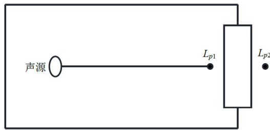
图 4-4 室内声源等效为室外声源图例
