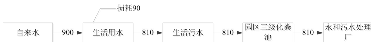
图 2-3 迁扩建后项目水平衡图 (单位 m 3 /a)
