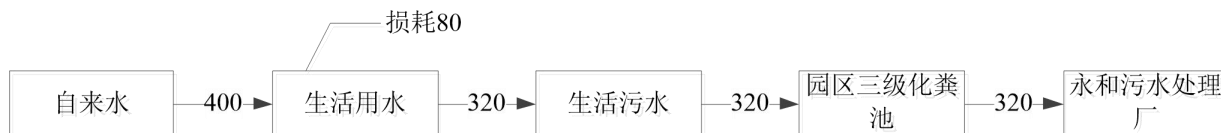
图 2-2 迁扩建前项目水平衡图 (单位 m 3 /a)
