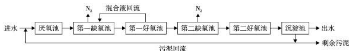
图 1 Bardenpho 工艺流程
