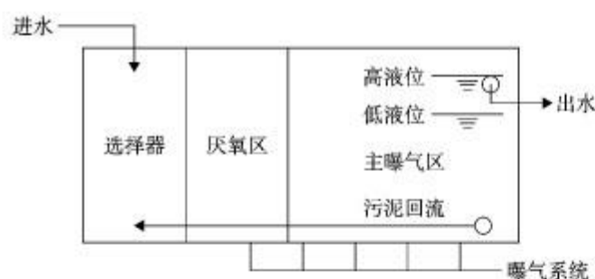
图6 CAST脱氮除磷工艺流程
