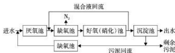
图 5 JHB 工艺流程
