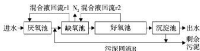
图 3 UCT 工艺流程
