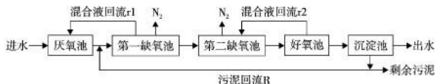
图 4 M-UCT 工艺流程
