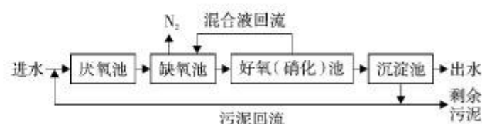
图 2 \text{A}^2/\text{O} 工艺流程
