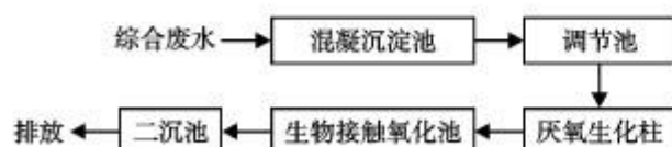
图 1 废水生化处理试验工艺流程
