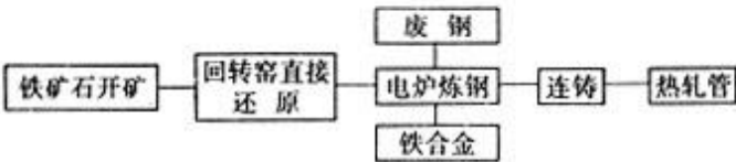
图 3 直接还原-电炉流程(DRI/EAF)CO 2 排放边界
