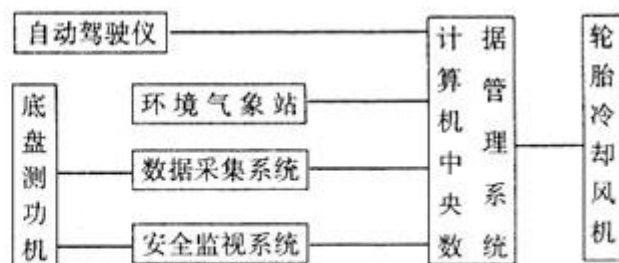
图2 耐久性能测量设备基本结构示意图
