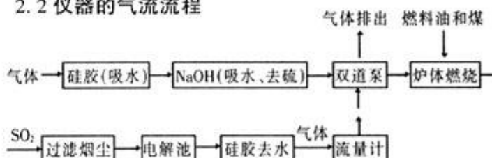
图 1 仪器的气流流程图
