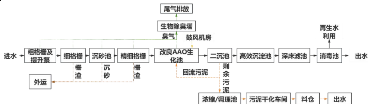
图7.1-1 生活污水处理系统工艺流程图
