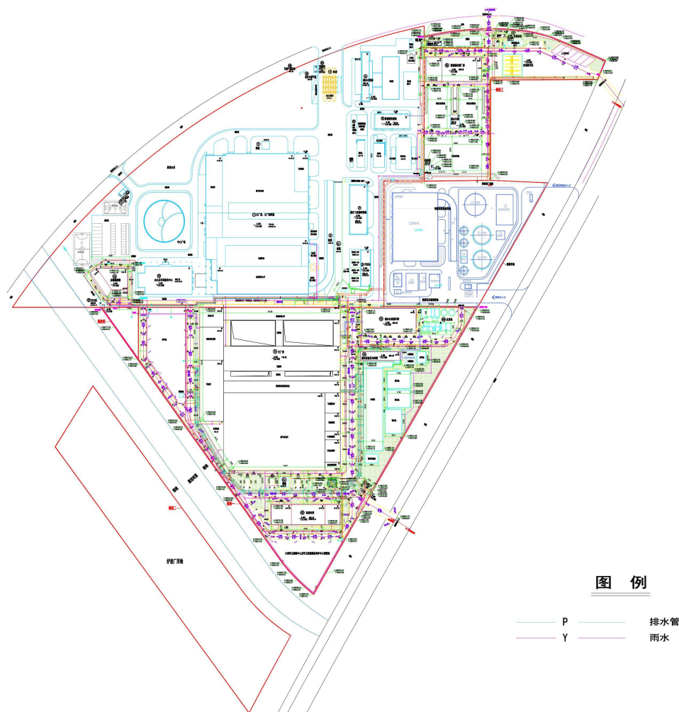
图 6.9-5 雨污管网布置图
