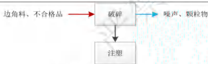
图 2-5 破碎工艺流程图
