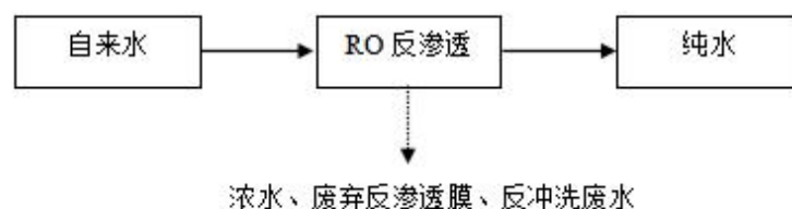
图 2-5 纯水制备工艺流程及产污图
