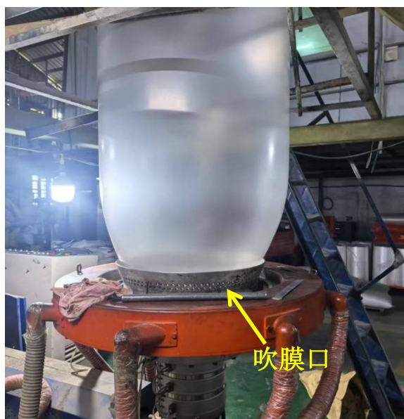
图 7 吹膜机吹膜口示意图
