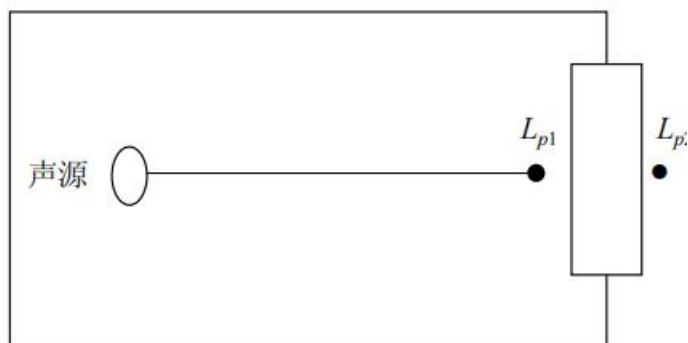
图 4-1 室内声源等效为室外声源图例
