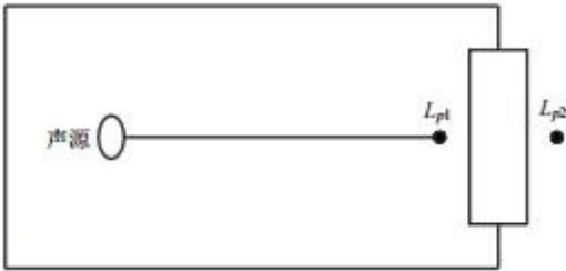
图 4-2 室内声源等效为室外声源图例
