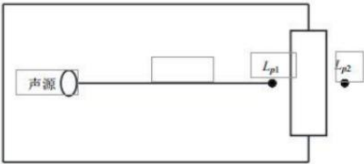
图 4-1 室内声源等效为室外声源图例
