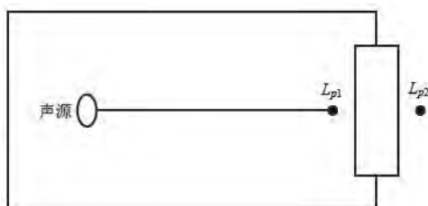
图 4-2 室内声源等效为室外声源图例
