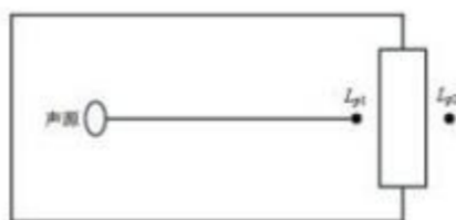
图 4-2 室内声源等效为室外声源图例
