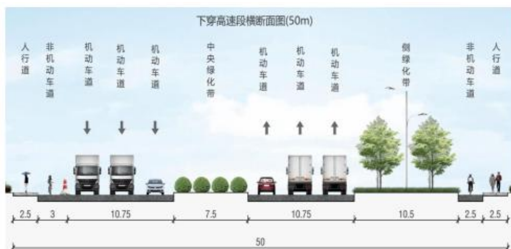
图 2-3 凤凰五路北延线下穿北三环高速横断面
