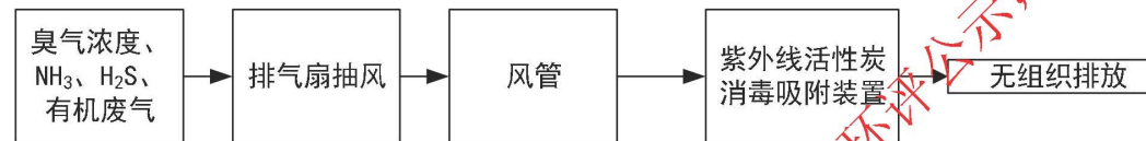
图 4-1 废气治理工艺流程图
