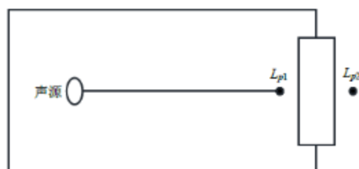
图 4.7 室内声源等效为室外声源图例
