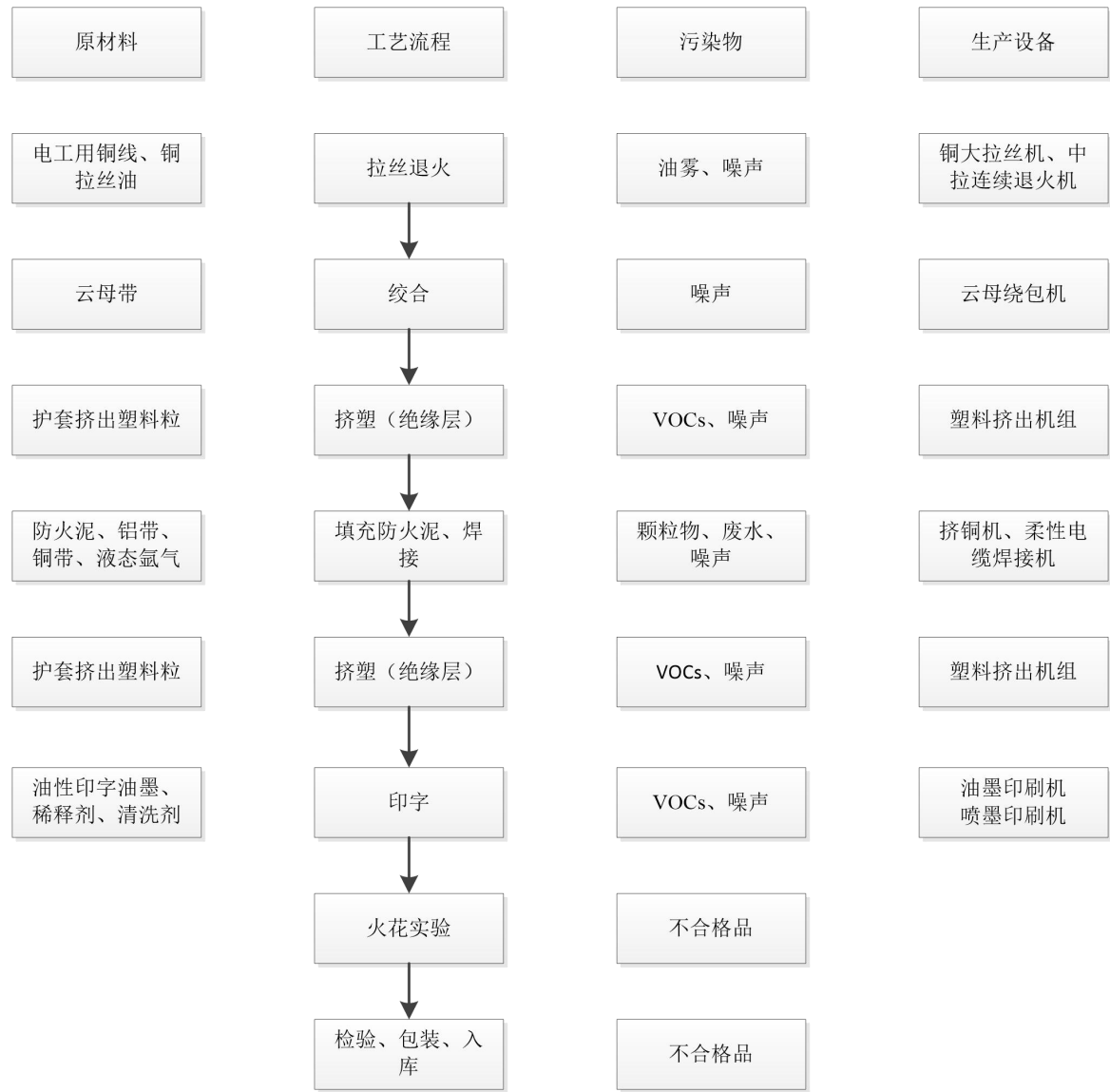
图 2-6 柔性矿物电缆工艺流程图
