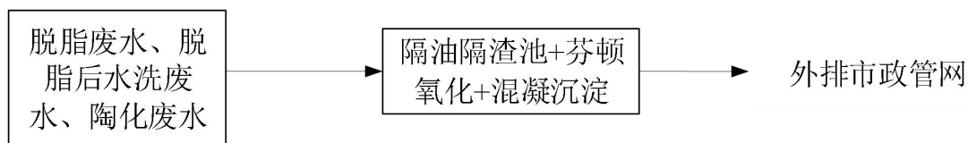
图 4-4 本项目自建生产废水处理设施工艺流程图
