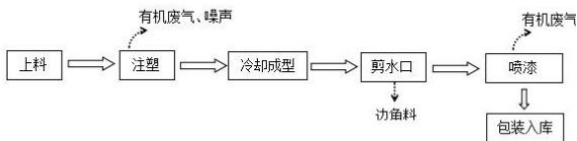
图 2-5 现有项目注塑件的生产工艺流程及产污环节图
