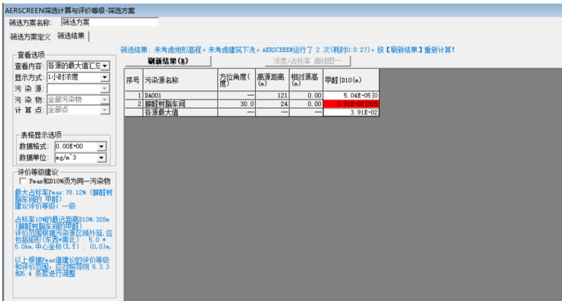
图 3-1 估算模型 AERSCREEN 计算结果截图 (第一张图为占标率, 第二张图为落地浓度)
