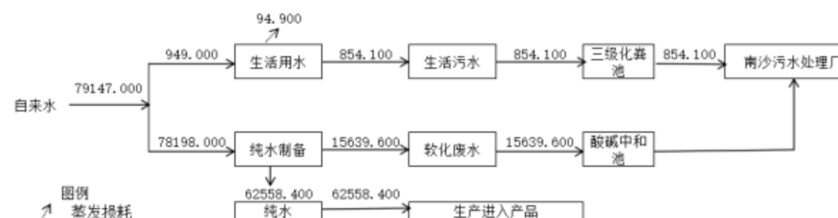
图 2-2 本项目扩建前水平衡图 (单位: t/a)
