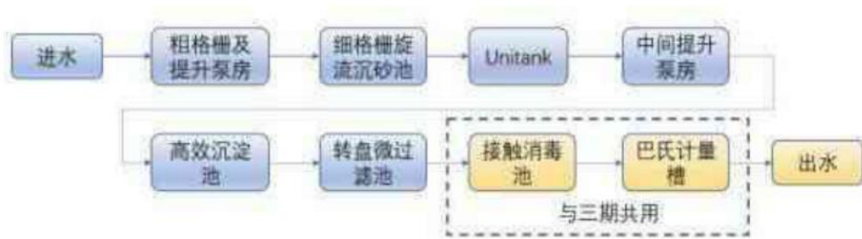
图 4-1 前锋净水厂一二期污水处理工艺流程图
