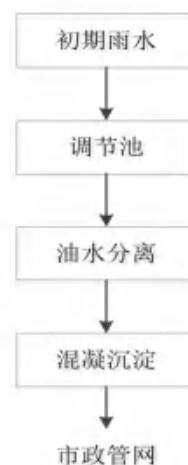
图 4-2 “隔油+混凝沉淀”处理工艺流程图
