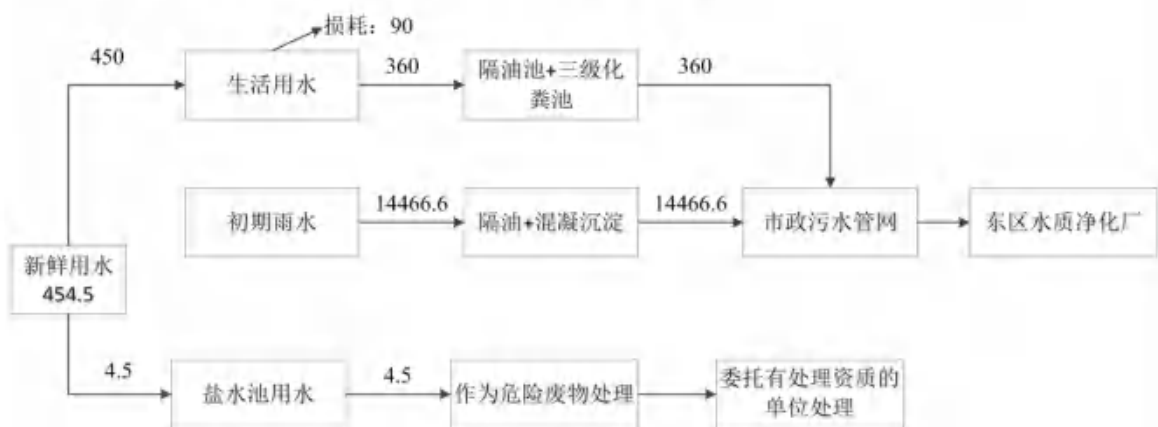
图 2-1 扩建项目水平衡图 单位：t/a
