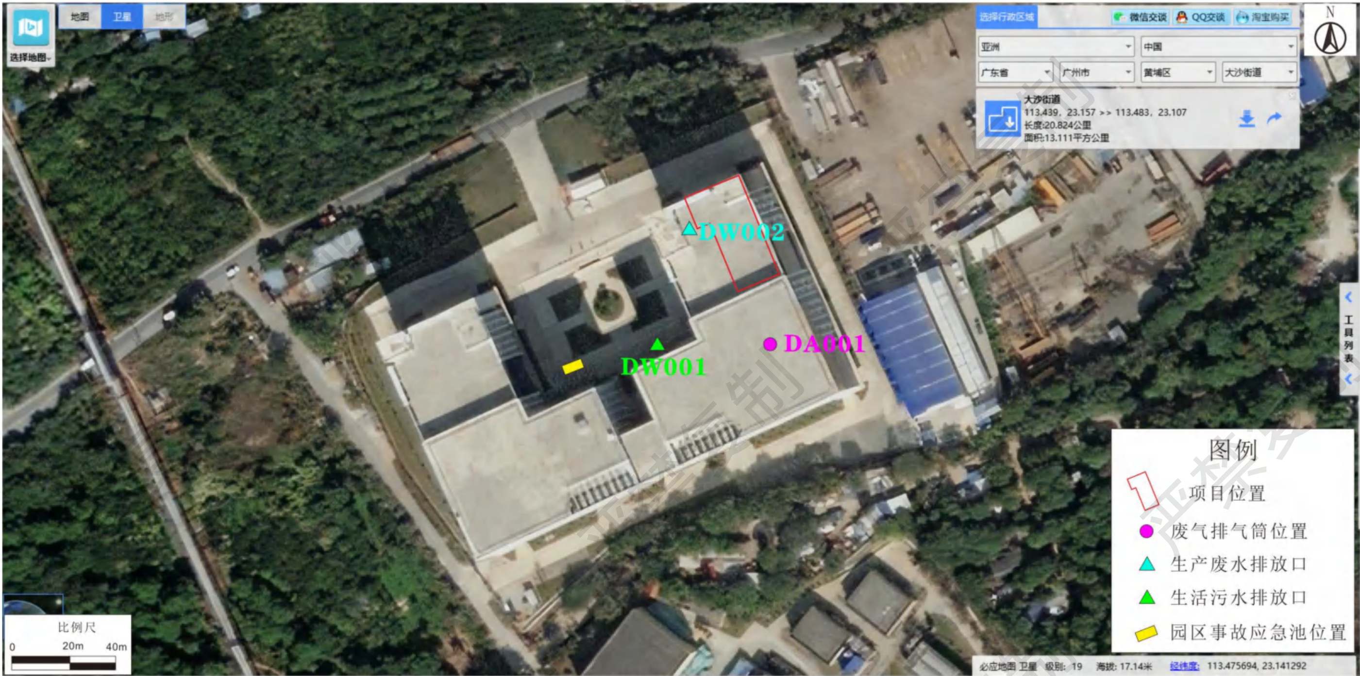
图2.1-4 本项目废气排气筒、废水排放口位置及园区事故应急池位置图
