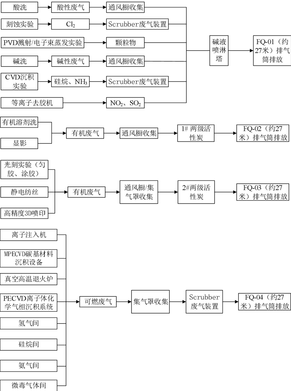
图 4-1 本项目废气处理工艺流程图
