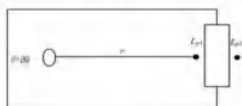
图 4-4 室内声源等效为室外声源图例
