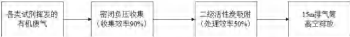
图 12 项目有机废气收集处理工艺示意图
