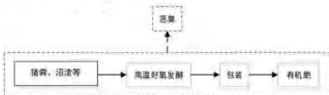
图 5 堆肥工艺流程图
