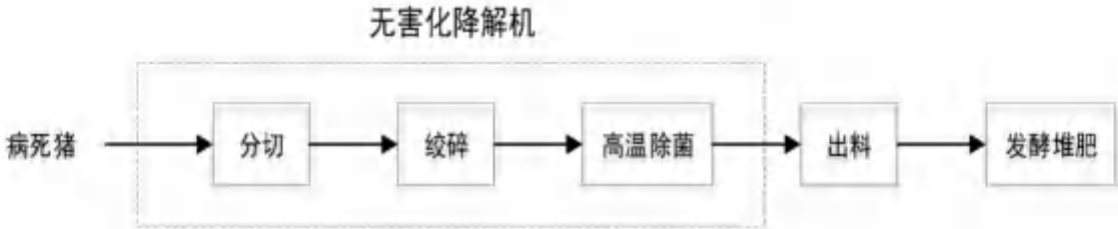
图 6 病死猪无害化处置工艺流程图
